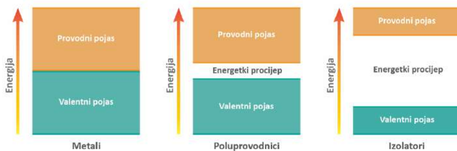
Slika 18. Komparacija energetskog procijepa između valentnog i provodnog pojasa u metalima, poluprovodnicima i izolatorima. Kod metala energetski procijep je gotovo nepostojeći, kod poluprovodnika je mali a kod izolatora veoma velik, što promociju elektrona iz valentnog u provodni pojas čini teškom
